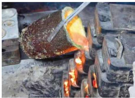
*Auch recyceltes Messing wird verwendet: Das flüssige Messing wird in die vorbereitete Sandform gegossen.*
